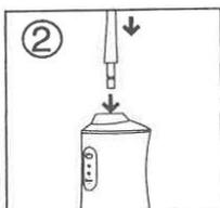
Inserire l'ugello corrispondente nell'impugnatura, assicurandosi che sia saldamente in posizione per evitare perdite d'acqua durante l'uso
